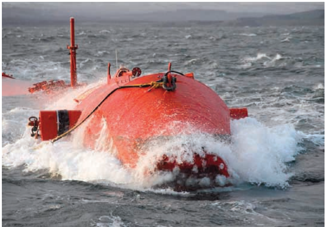
■ Pelamis: prototype 750 kW (Pelamis Wave Power)
