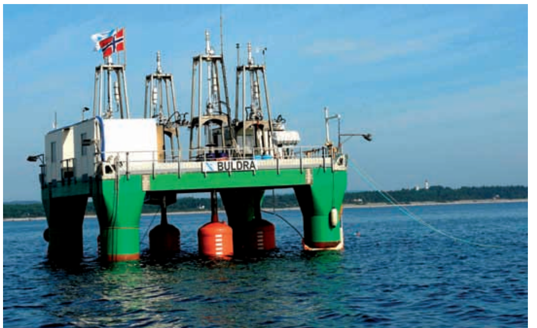
■ FO 3 een punt-absorptiesysteem ontwikkeld in Noorwegen (SEEWEC)
