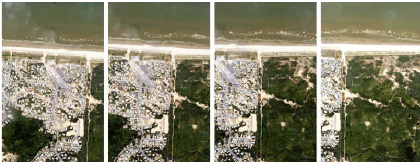
■ Opeenvolgende vliegtuigopnamen in de kustduinen, genomen met een digitale camera. Tussen de aangrenzende beelden is 80% overlapping. De grens tussen de groene vegetatie aan de rechterzijde van het beeld en de bebouwing aan de linkerzijde valt samen met de grens tussen België en Frankrijk (VITO)
