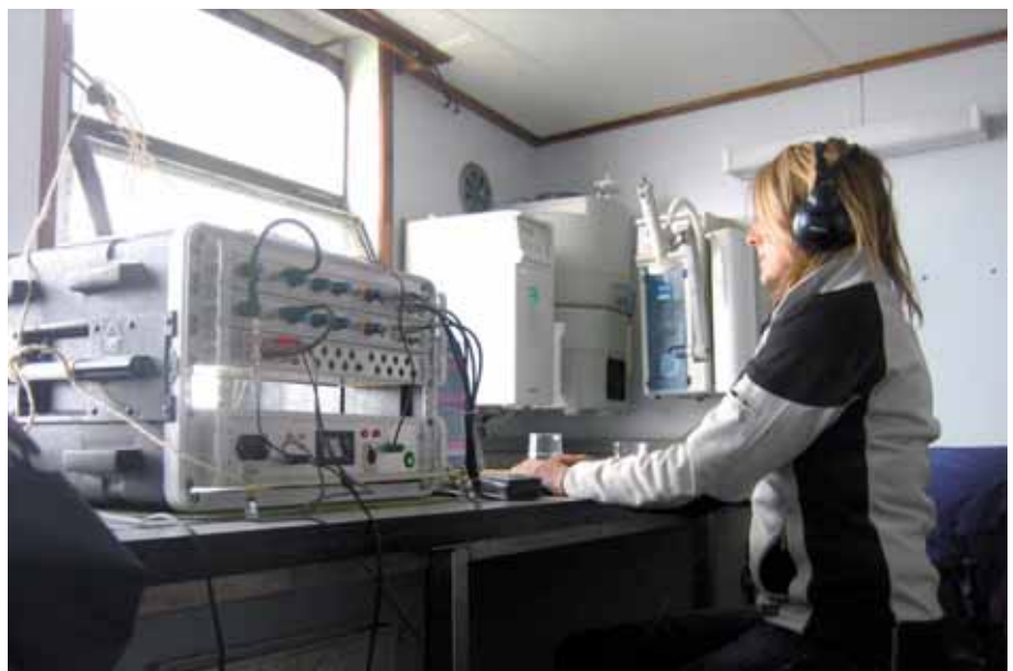
In het kader van de systematische vogel- en zeezoogdierentellingen van het Instituut voor Natuur- en Bosonderzoek (INBO), verzorgt het VLIZ de aankoop, het beheer en de bediening van een Passive Acoustic Monitoring Systeem (PAM). Deze hydrofoons zijn een bijkomende bron van informatie over het voorkomen van bruinvissen en andere dolfinachtigen op het Belgisch deel van de Noordzee.
