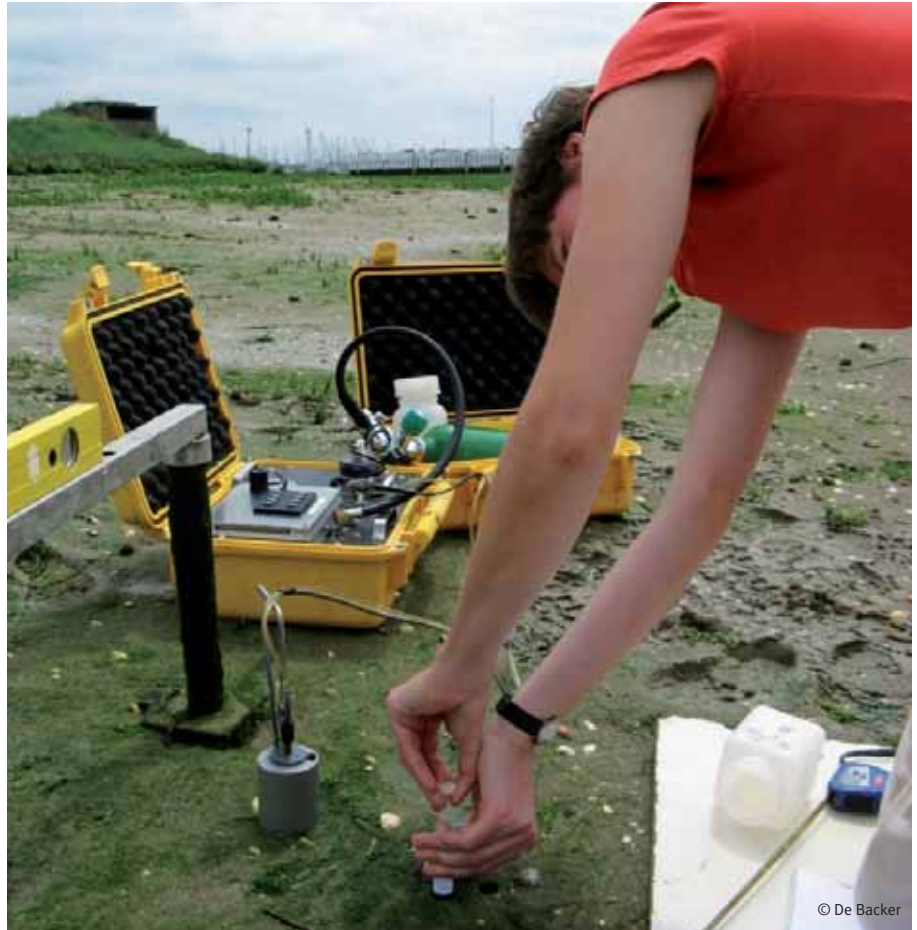
Om de erodeerbaarheid van sedimenten te meten in het veld (of in laboratoriumexperimenten) wordt een draagbare Cohesive Strength Meter (CSM) gebruikt; hier op de slikken van de Uzermondung door onderzoekers van de Sectie Mariene Biologie - UGent.
