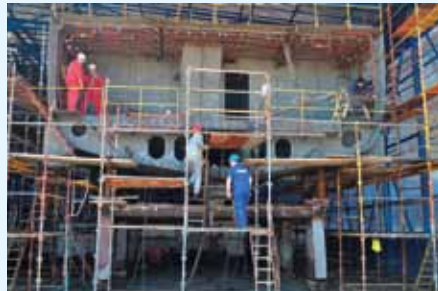
juni 2011: boegstuk met cabines voor wetenschappers en de boegschroefkamer
