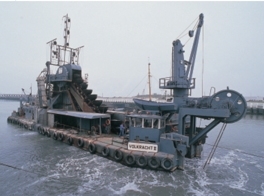
De emmerbaggermolen is het oudste baggerwerktuig nog actief aan onze kust. Hier de 'Volkracht II' in volle actie in de haven van Oostende (MD)
