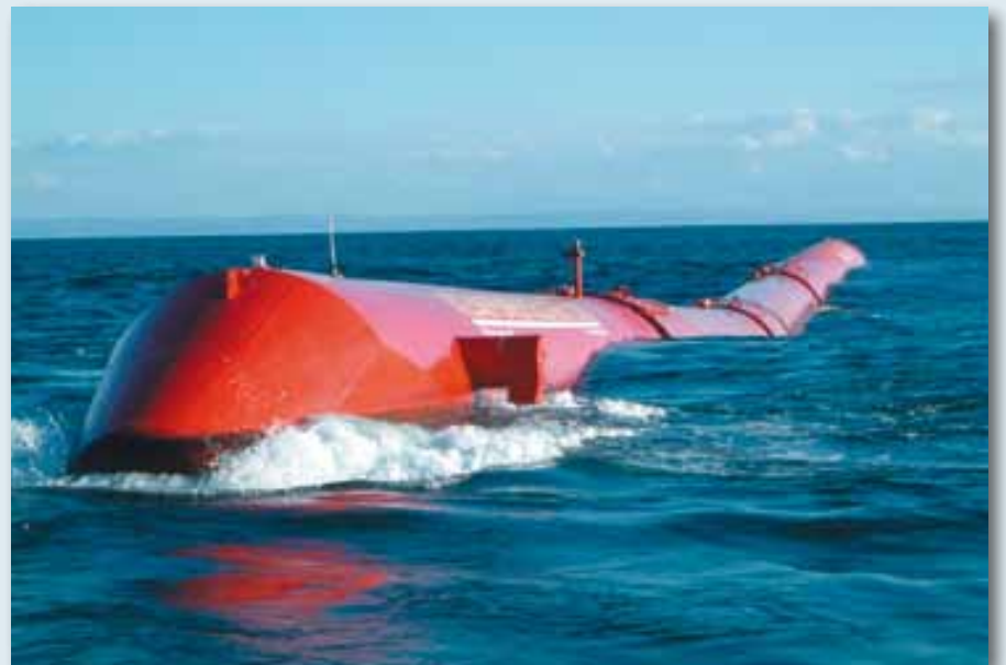
Pelamis, de drijvende golfenergieconverteur. Deze 140 meter lange, torpedovormige convertoren bewegen mee met de golven van de zee. Ze zijn verbonden met een hydraulisch systeem dat de golfbeweging gebruikt om onder hoge druk olie in enkele hydraulische motoren te pompen. Die motoren drijven dan weer generatoren aan die elektriciteit produceren. ©Pelamis
