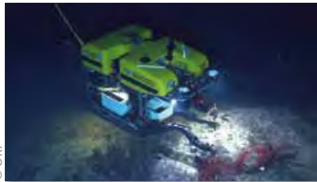
ROV neemt monsters van de zeebodem voor wetenschappelijk onderzoek
