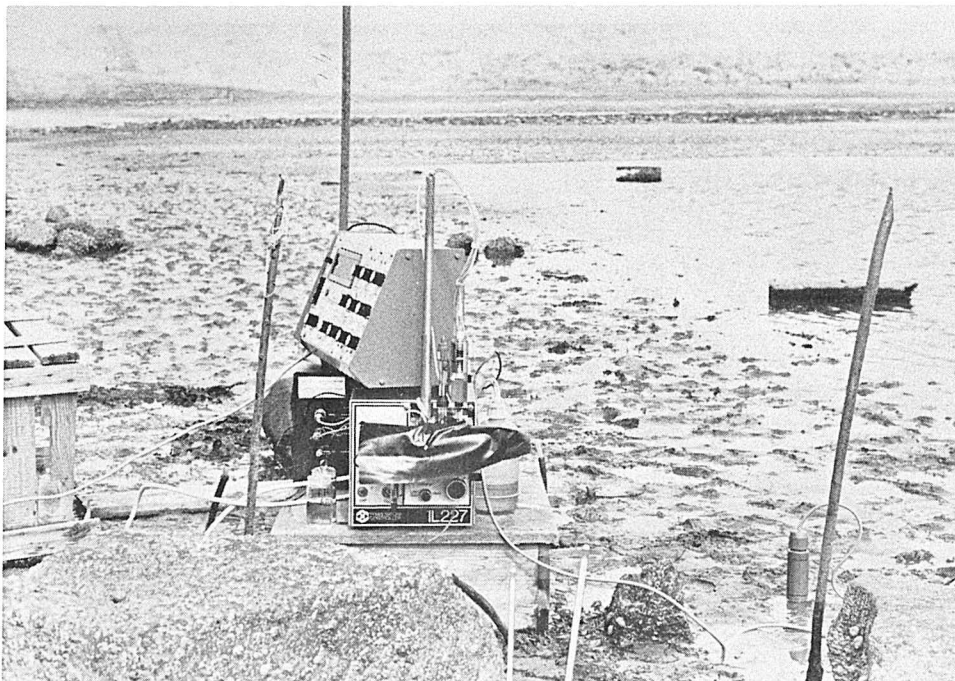
Fig. 5. Apparatuur voor de meting van pO 2 , pH en temperatuur in het interstitiële water van de wadbodem.
