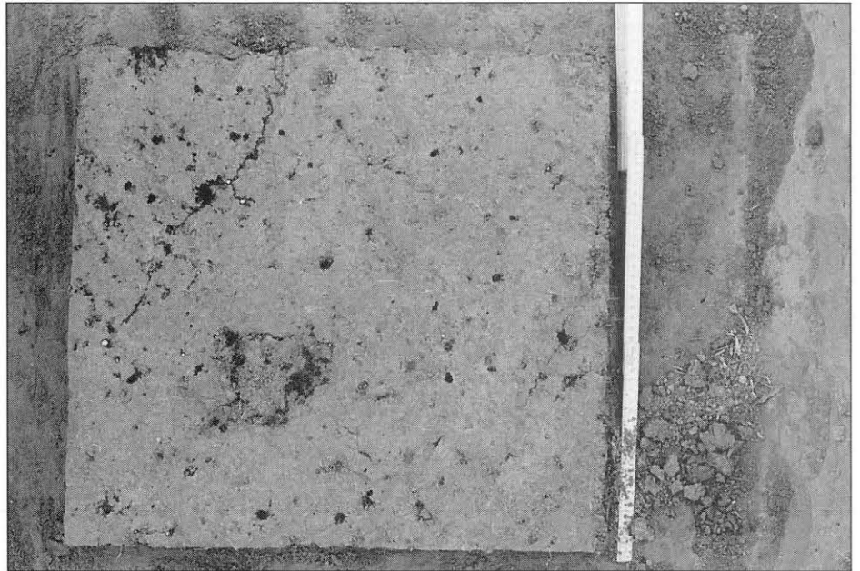
Foto 2: Methyleenblauw heeft de eigenschap te adsorberen op kleipartikels. Door het toevoegen van deze kleurstof aan het infiltrerende water worden macroporiën en preferentiële stroombanen zichtbaar doordat deze blauw gekleurd zijn. Deze foto toont het voorkomen van macroporiën in een horizontale coupe in een zandleembodem (Bekkevoort) op een diepte van 13 cm.
