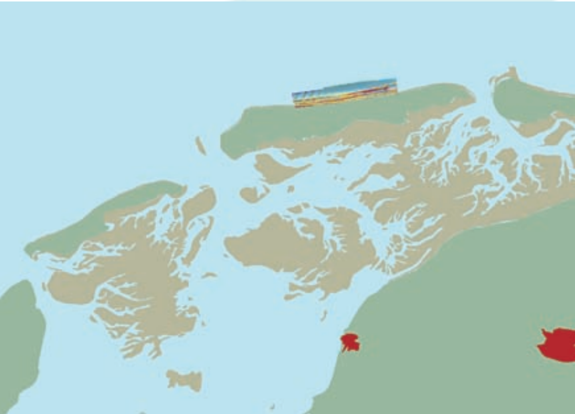
3D-weergave van de bodem bij Terschelling. Een blik in de trog tussen de buitenste twee banken. In het midden, als een bult, de onderwatersuppletie van 1993. (Hemel: verschilbeeld bodemligging tussen 2000 en 1993. Rood: sedimentatie; blauw: erosie.)
