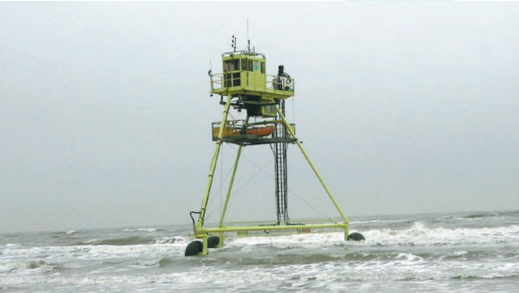
De WESP, een elf meter hoge ‘rijdende peilstok’ voor metingen op het strand en de zeebodem tot circa zes meter diepte.
