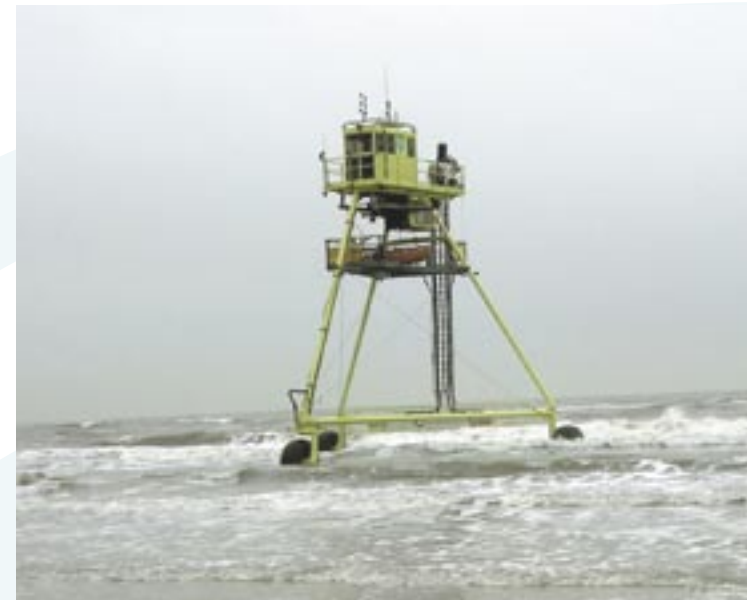
De WESP, een elf meter hoge 'rijdende peilstok' voor metingen op het strand en de zeebodem tot circa zes meter diepte
