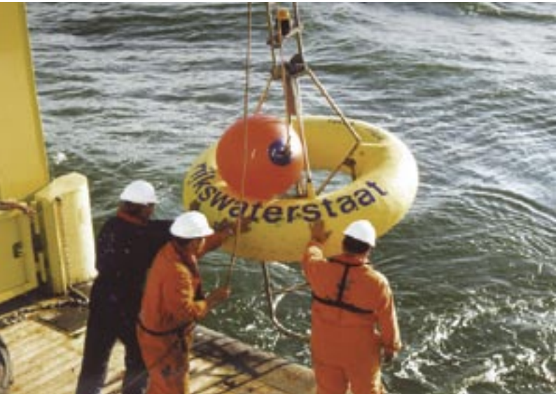
Metingen naar het zandtransport bij Noordwijk in het kader van het EU-project SANDPIT. Hiermee kunnen we het morfologisch gedrag van zandwinputten beter begrijpen.
