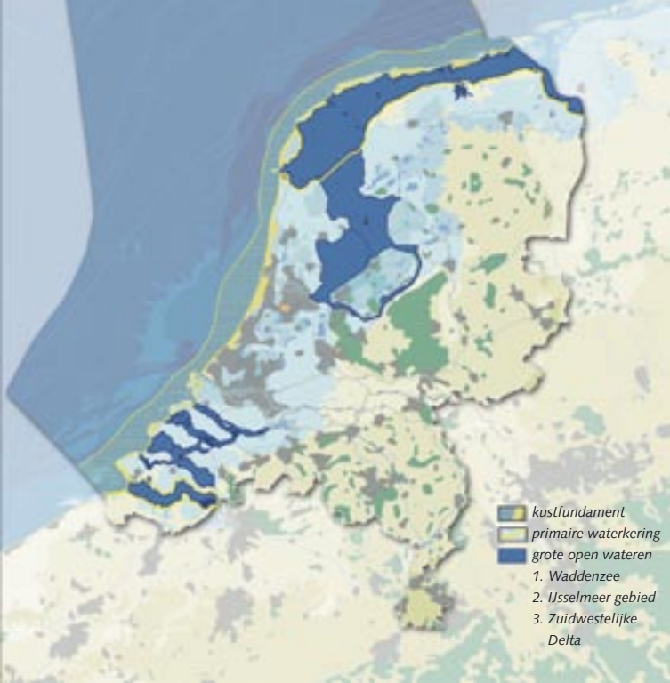
Het kustfundament strekt zich uit van de duinen tot 20 meter diepte op zee.
