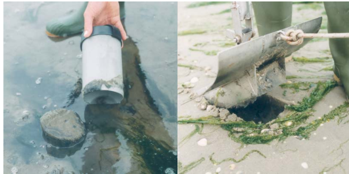
Figuur 1 steekbuis (links) en kokkelschuif (rechts) die worden gebruikt voor de IMARES-survey (Bult et al, 2004).
