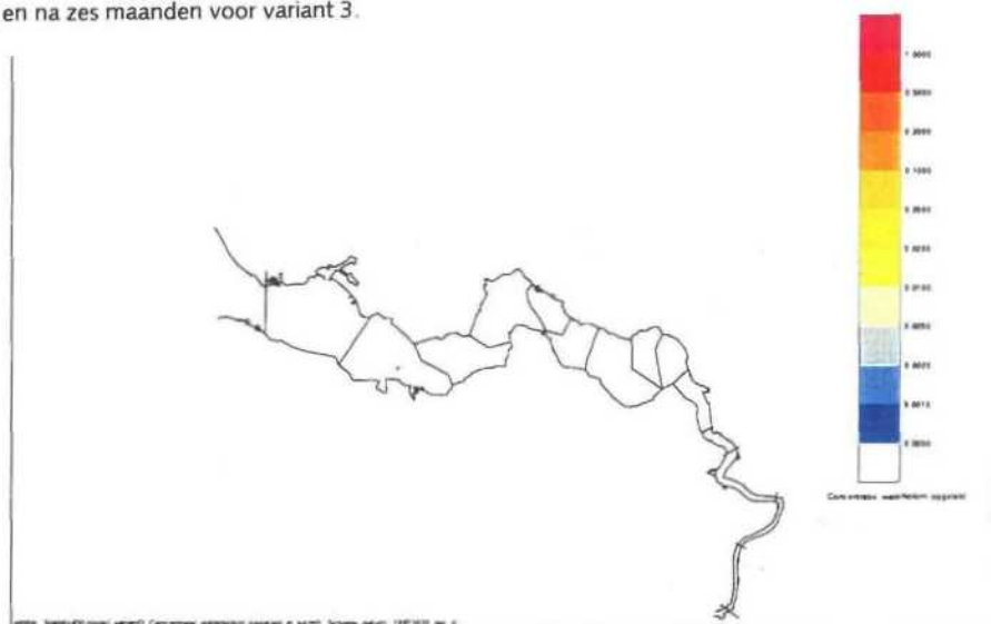
Figuur 3.1: Stortlocatie, slibconcentratie (in g/l) aan het eind van de stortperiode en na zes maanden voor variant 3.
