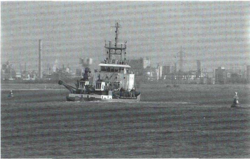
41. Onderhoudsbaggerwerk op de drempels is noodzakelijk om de vaargeul overal op een minimale diepte te houden.
