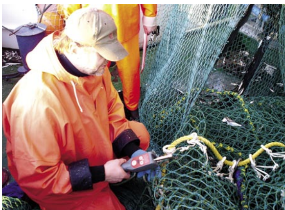
Abbildung 1: Wissenschaftler bei der Messung von T90-Steertmaschen mit dem OMEGA-Maschenmessgerät, das jetzt als Standardmessgerät des ICES definiert ist.
