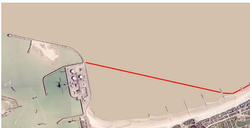
Figuur 17 – Prognose van de evenwichtskustlijn die voorzien wordt bereikt te worden binnen enkele decaden
