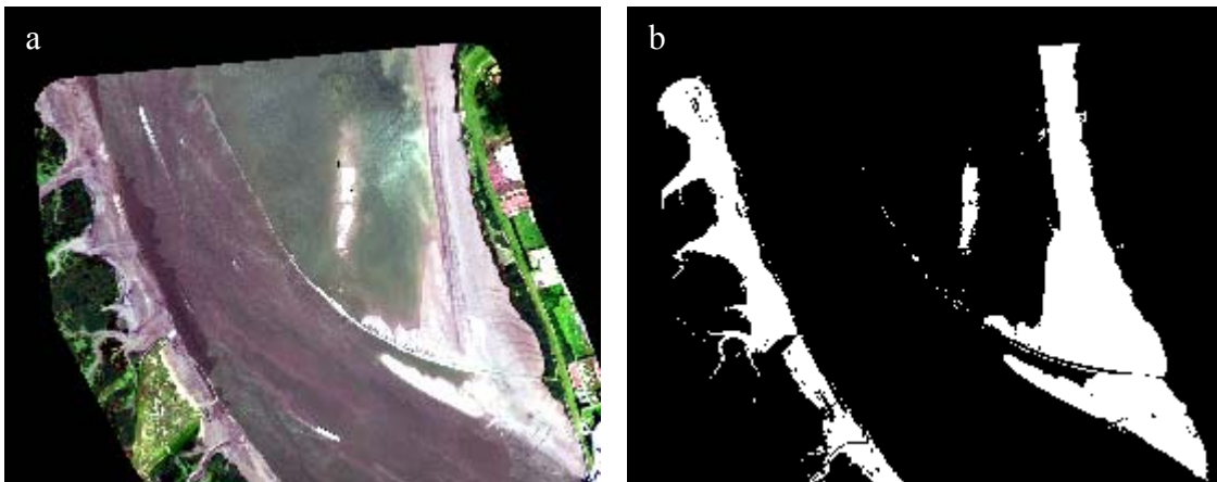
Figuur 22. a) RGB voorstelling van het hyperspectrale beeld van het volledige deelgebied Schelde_1a. b) Het platen- en slikkenmasker (M7) van het volledige deelgebied Schelde_1a.
