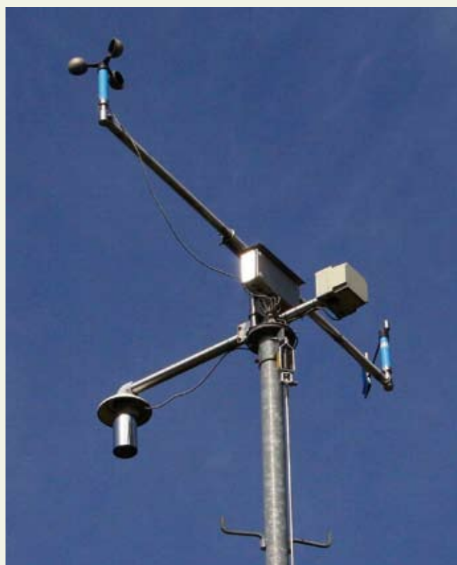
FIGUUR 4.2. Anemometer, windwijzer en temperatuursensor op de mast van tien meter in Mont-Rigi.
