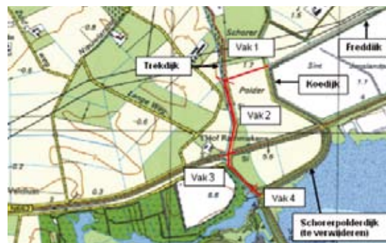
Figuur 5.6 Tracé en dijkvakken nieuwe primaire waterkering
