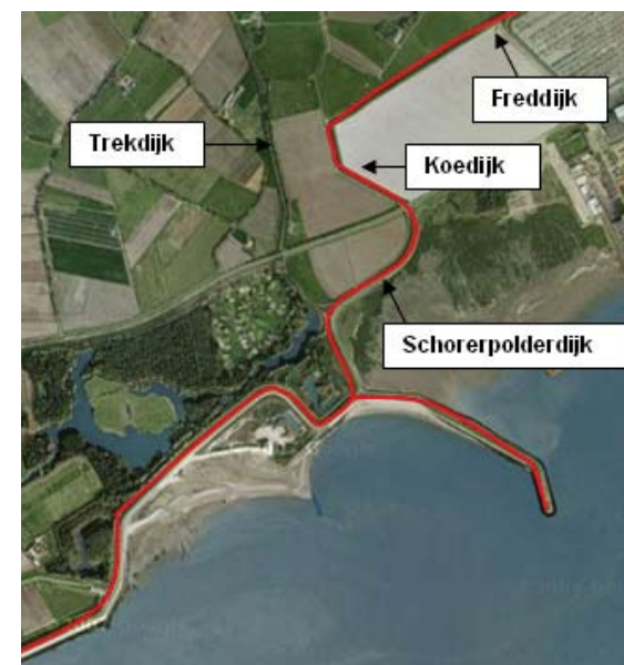
Figuur 4.4 De bestaande primaire waterkering
