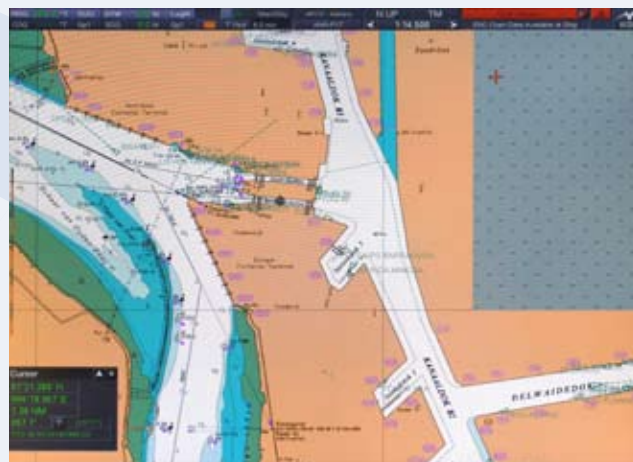
De loodsen maken gebruik van een navigatiesysteem waarmee ze tot op centimeters nauwkeurig de positie van het schip kunnen bepalen
