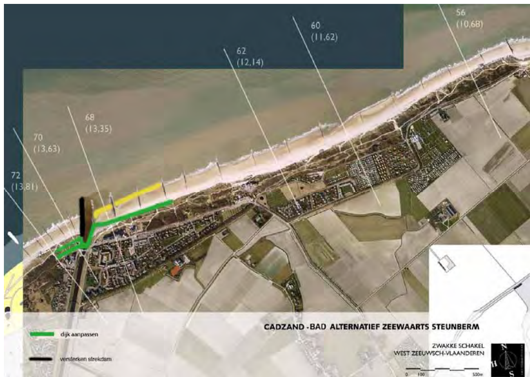
Figuur 3-4 Alternatief Zeewaarts Steunberm Cadzand-Bad
