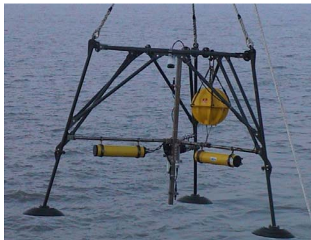
Foto 2. Tripode voorzien van SonTek ADV en ADP, 2 SonTek Hydra, SBE37, 2 OBS en LISST-100X
