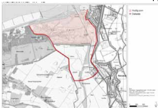
Alternatief 1A = uitbreiding door ca. 120 ha ontpoldering Alternatief 1B = 1A + spuibecken 20 ha
