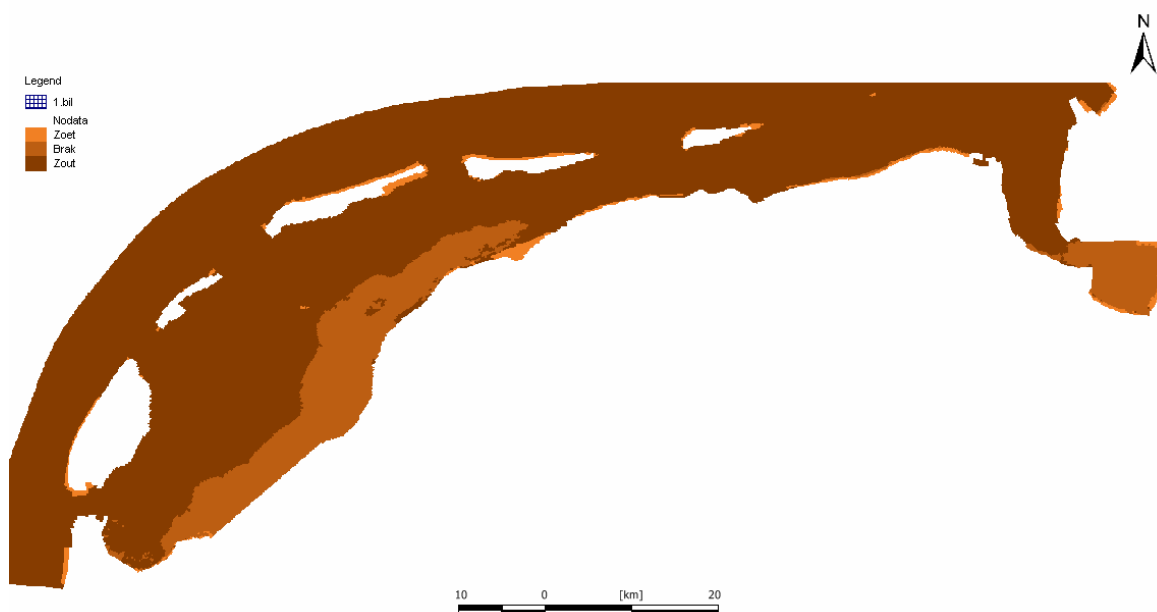
Figuur 4.6 Gemiddeld zoutgehalte in de Waddenzee uitgedrukt in saliniteit. Zoet = < 5.4, Brak= 5.4 - 18 en Zout = >18
