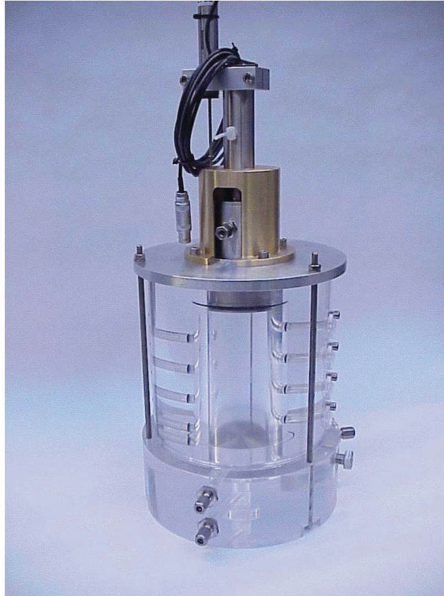
Figuur 2 Foto van de frostheave cel
