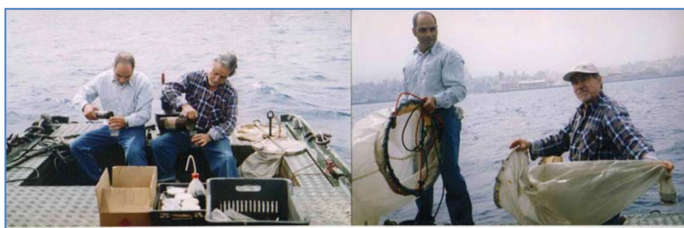
Fig. V.3b-Pêche du plancton au large de Byblos 15 Mars 1993 au bord d'une barque de pêche, utilisant 2 sortes de filets ; 1: Filets 52 \mu et 200 \mu de 1.20 cm de long et 40 cm de diamètre, couplés sur système Bongo. 2:Filet fermant de 75 cm de diamètre, maille 200 \mu et 2.50 m de long.
