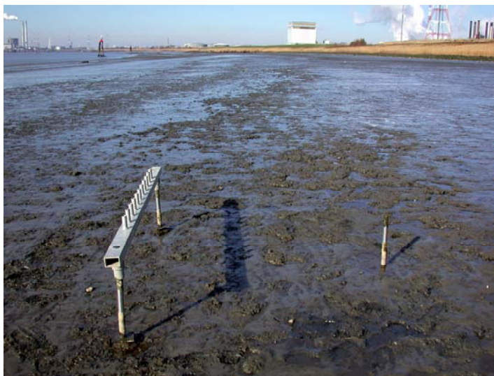
Figuur 4-7: Sederoplot voor het opmeten van sedimentatie/erosie (foto Jan Soors).
