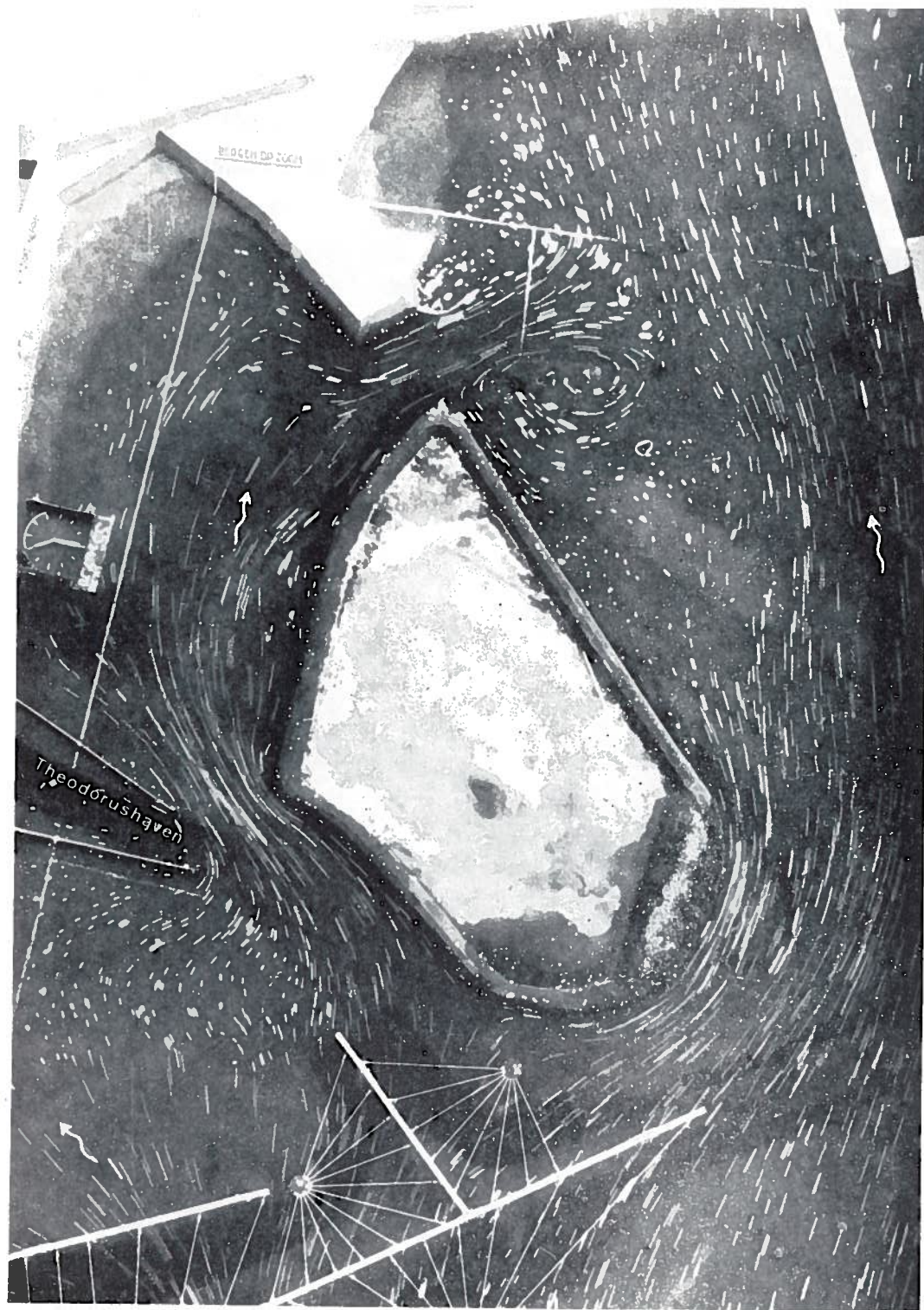
Figuur 106. T35A hoge vloed, 17.00 uur Oppervlactestroombeeld Molenplaat Lengteschaal 1 : 20.000 Snelheidsschaal 1 cm \Delta 1,67 m/s
