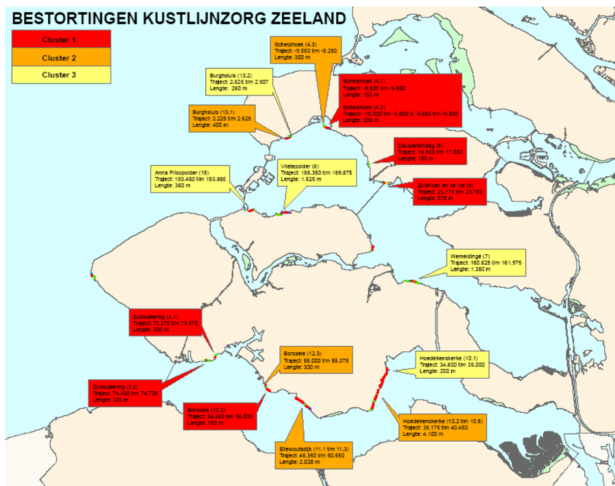
Figuur 1: Geplande bestortingen in het Nederlands Deltagebied t.b.v. dijkversterking, opgedeeld in 3 fasen: Cluster 1: reeds uitgevoerd, Cluster 2: in voorbereiding, Cluster 3: mogelijke uitvoering in de toekomst.
