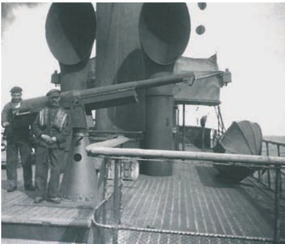
■ Eine klassische 75-mm-Kanone, montiert auf einem Untersatz aus dem Jahr 1916. Viele Handelsschiffe wurden mit diesem Kanonentyp ausgerüstet. (14/18 auf See, Belgische Schiffe und Seeleute im Großen Krieg, Freddy Philips)
