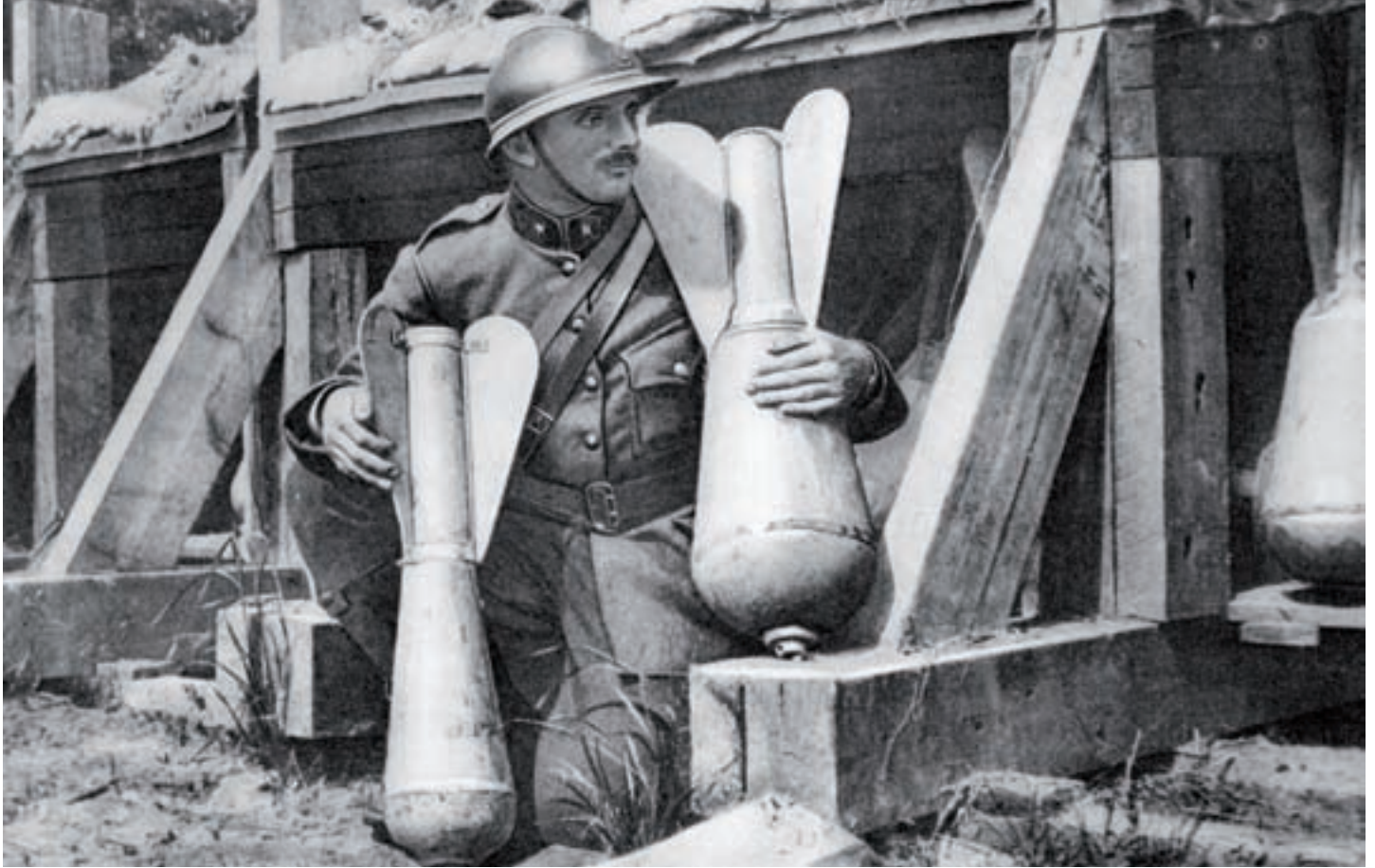
■ Aufgrund der großen Stabilisierungsflossen können diese Mörsergranaten bei ihrem Flug auf Kurs bleiben. (Luc Vandeweyer)
