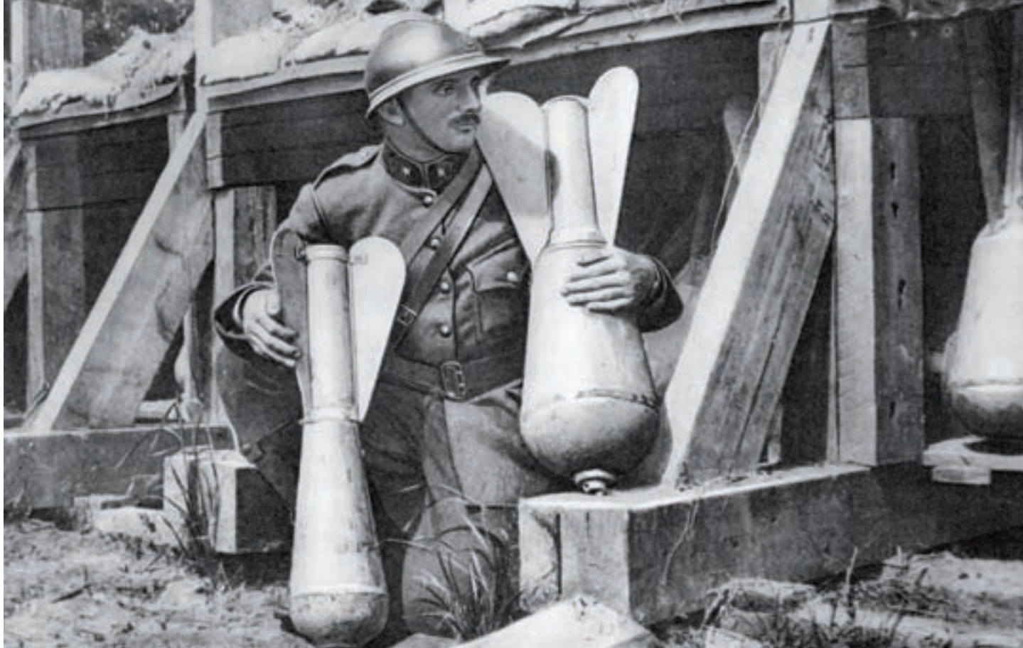
■ Grâce à leur grands ailerons stabilisateurs, ces obus de mortier peuvent garder le cap pendant leur trajectoire dans les airs (Luc Vandeweyer)
