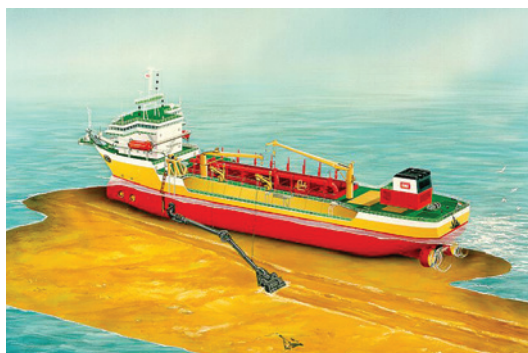
Figure 6 : Esquisse d'une drague à élinde traînante (à gauche) et photo du déchargement de sable marin (à droite)
