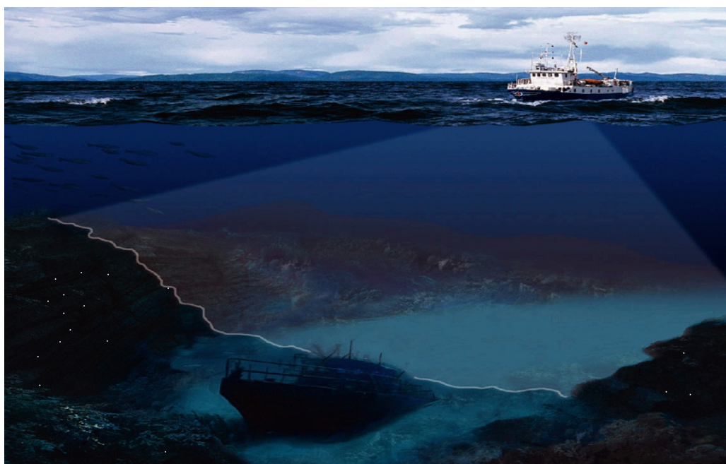
Figure 8 : Principe général d'un sondeur multifaisceaux (Source : Kongsberg Maritime)
