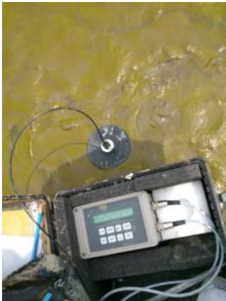
Figuur 6.26: Euglena domineert het MPB op station AP3. Hier wordt een rapid light curve gemeten m.b.v. een waterPAM met EDF fiberoptic detector unit.
