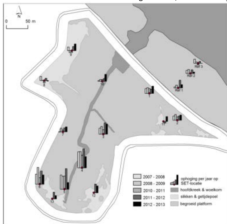
Figuur is een ruimtelijke weergave van de ophoging van de meetlocaties in het Lippenbroek tot 2012.
