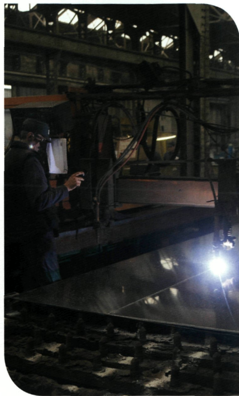
machinaal versnijden van de stalen platen © Franky Bruneel
