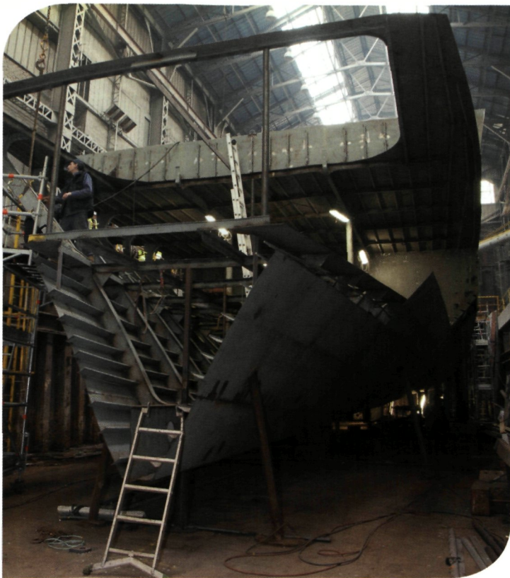
De verschillende bouwblokken vormen samen de romp van de Castor © Philip Loose
