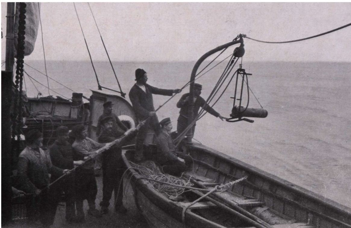
Een planktonmeter met sifon wordt hier te water gelaten vanop de West-Hinder in de periode voor 1914 ( Gilson, 1914 ).
