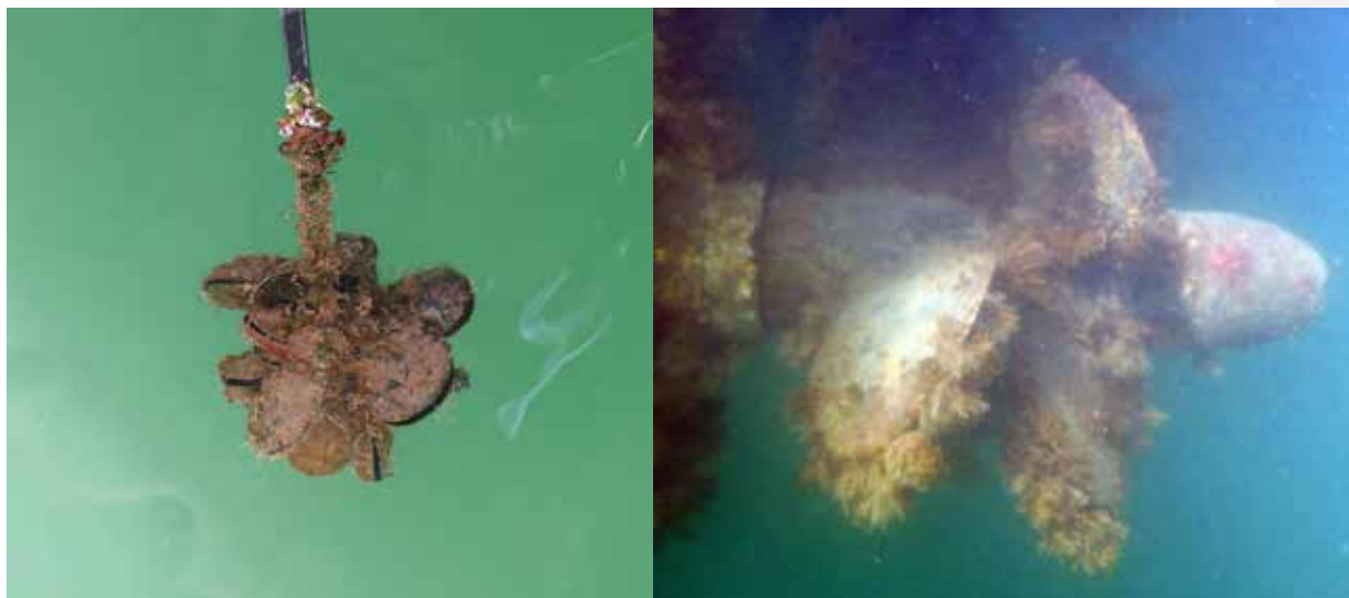
Figura 3.36 - Exemplos de fouling em equipamentos de embarcações. [Fotografias: Paulo Frias e Filipe Henriques].
