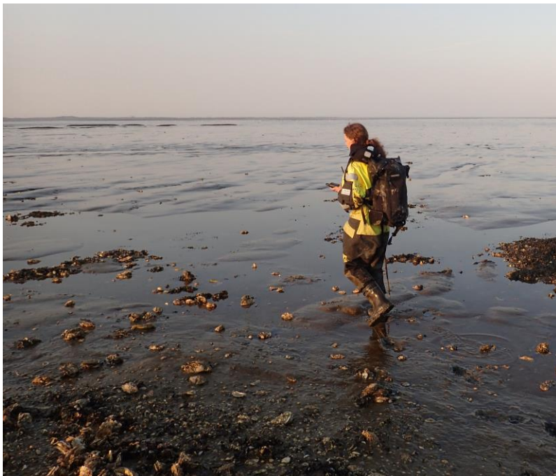
Figuur 3: Aan de hand van een hand GPS wordt naar een monsterpunt genavigeerd om daar met de steekbuis een bodemonster te nemen.
