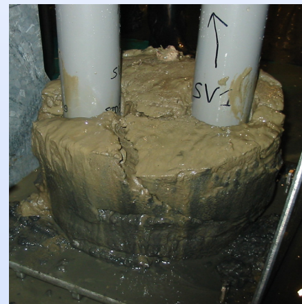
Stortplaats gelegen in geul: afwisseling zand- en sliblagen (typische getijden/storm sequentie)
