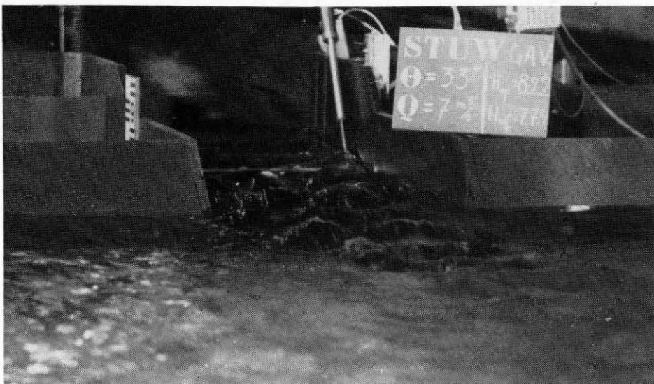
Model van de stuw op de Gaverbeek. Zicht op de spontane golfvorming afwaarts van de klep.
