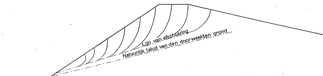
Fig. 62. Glijdvlakken in een doorweekt binnenbeloop.
