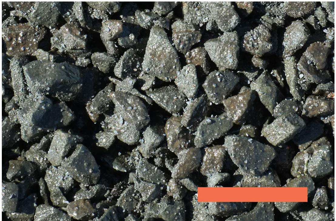
Figuur 1 Elastocoast®, breuksteen verlijmd met polyurethaan met open structuur direct na aanbrengen op de strandhoofden. Het oppervlak van de stenen is verruwd met brekerzand. De maatlijn is 10 cm lang.
