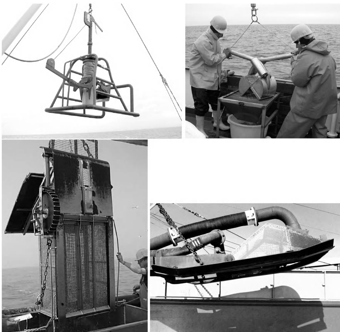
Fig. 1. Monstertuigen gebruikt bij onderzoek naar macrobenthos: box-corer (rechtsboven), Van Veen gripper (linksboven), bodemschaaf (linksonder) en hydraulische kor (rechtsonder).
