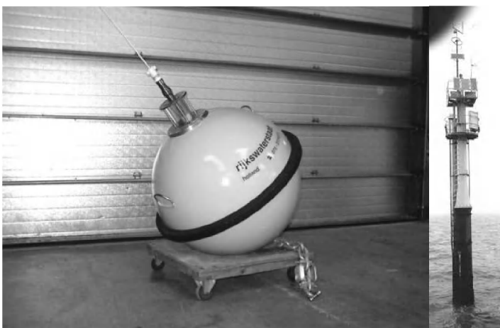
Fig. 2. Meetboei Deurloo (links) en Meetpaal Vlake van de Raan (rechts) binnen het ZEGE Meetnet
