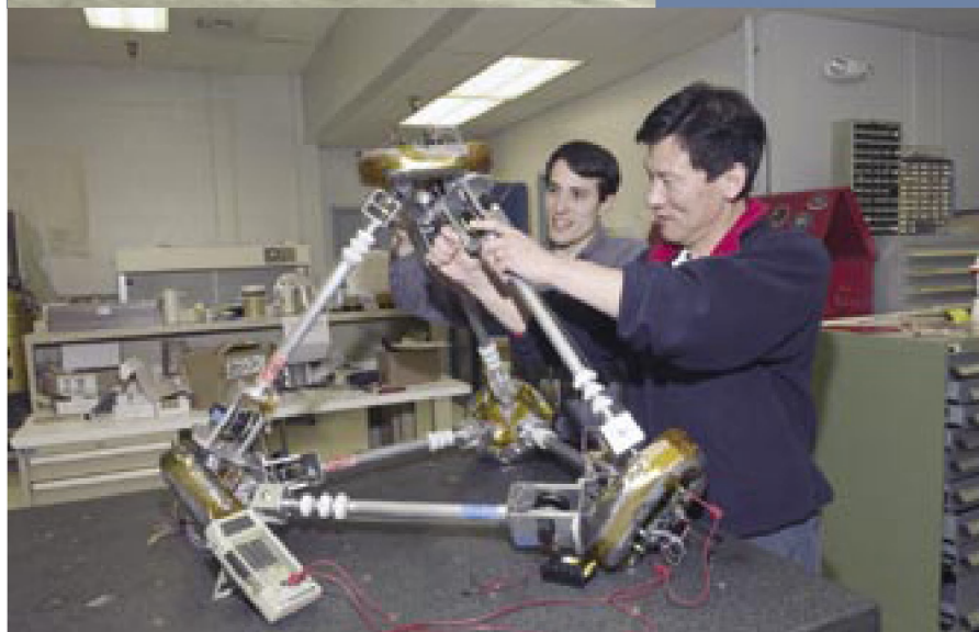
Amerikaans prototype voor een robot in de vorm van een tetraëder. De bedoeling is dat dergelijke robots in de toekomst in grote aantallen en met veel compactere afmetingen gemaakt zouden worden. Ze zouden dan gezamenlijk een buitengewoon veelzijdige en flexibele groep ruimteverkenners vormen. Let op de uitschuifbare staven die het 'skelet' van de robot vormen. © NASA
