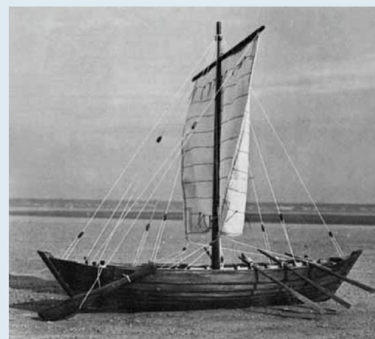
■ Stuurboord is de rechterzijde van een schip wanneer men vanop het vaartuig in de normale vaarrichting kijkt. Deze term gaat terug op de aanwezigheid van een stuurriem aan de rechterachterzijde van de houten schepen, zoals in onze contreien gebruikt tot in de middeleeuwen. Hier een model van het 'Schip van Brugge', opgegraven in 1899 tijdens graafwerken voor de nieuwe Brugse haven en als één van de best bewaarde Romeinse scheepswrakken beschouwd. De stuurriem achteraan rechts is duidelijk te zien (Desnerck & Desnerck, 1976)
