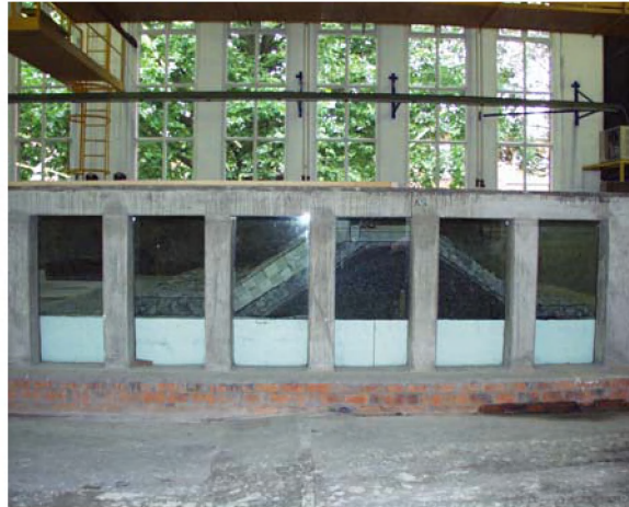
Figuur : dwarsdoorsnede van strekdam in de golfgoot
