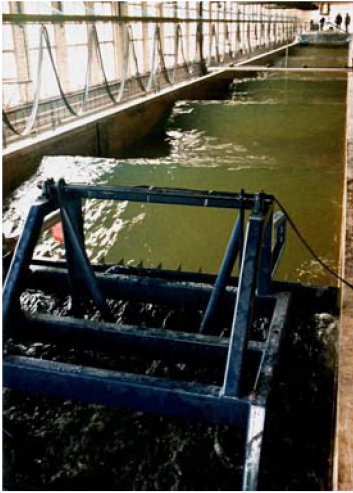
Figuur : Generatie van golven in golfgoot
