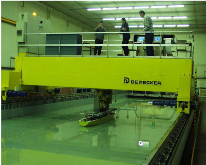
Figuur: de sleeptank voor krachtenonderzoek op schepen
