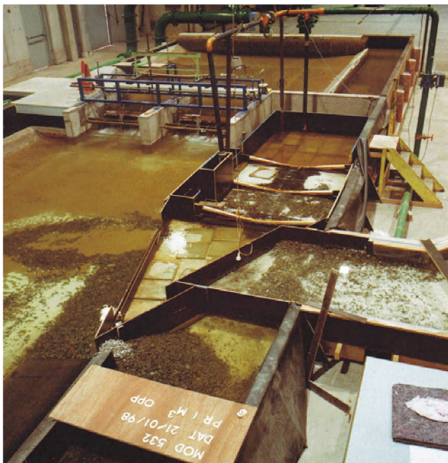
figuur: ontwerp vispassage ter hoogte van stuwen op de Bovenschelde
