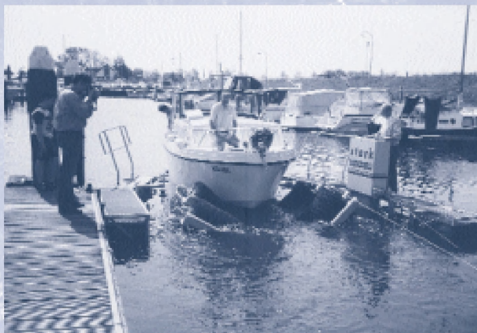
De Zeeuwse borstelbaan om schepen milieuvriendelijk van algen en pokken te ontdoen.
