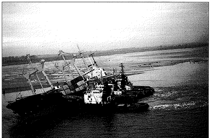
Sleepboten voorkomen dat het schip afglijdt naar de vaargeul
