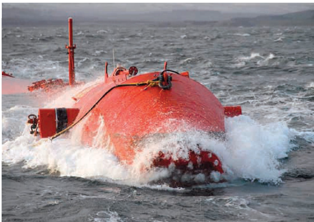
■ Pelamis: prototype 750 kW (Pelamis Wave Power)
