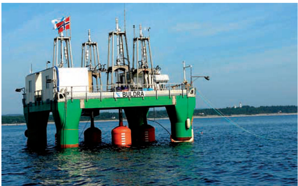
■ FO 3 een punt-absorptiesysteem ontwikkeld in Noorwegen (SEEWEC)
