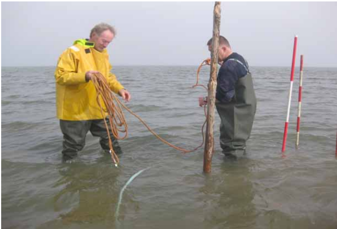
Foto 4: De dennenhouten paal als merk, gezet met hoogwater voor de juiste diepte-positie.
