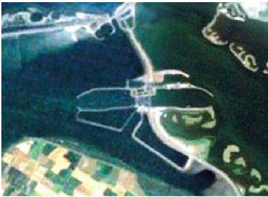
De hevel in de Grevelingendam introductie meer dynamiek in het Grevelingenmeer. De zoet-zoutscheiding in de Krammersluizen (Philipsdam) kan komen te vervallen. Via de aanpassingen van de sluizen of nieuw doorlaatmiddel vergroten van de uitwisseling tussen Volkerak-Zoommeer en de Oosterschelde.
